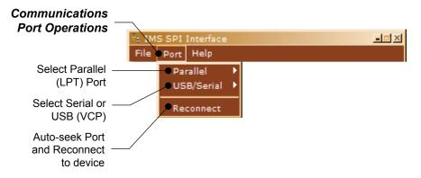
Figure 2.6.12: SPI Motor Interface Port Menu
